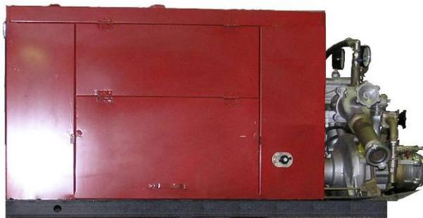
Стационарная пожарная установка СПУ-40/100 М предназначена для тушения пожаров водой или воздушно-механической пеной, для откачки воды при затоплении, для подачи воды в магистраль, перекачки воды и других подобных целей.
