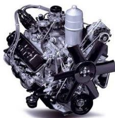
Мощный 8-цилиндровый двигатель создает большой крутящий момент на всех оборотах и позволяет максимально эффективно использовать потенциал пожарного насоса.
