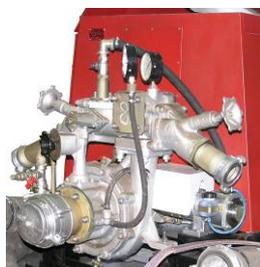
Пожарный насос ПН-40УВ обеспечивает подачу 50 л/с в номинальном режиме (55 л/с в форсированном режиме) при напоре более 100 м при частоте вращения вала насоса 2900 об/мин.
